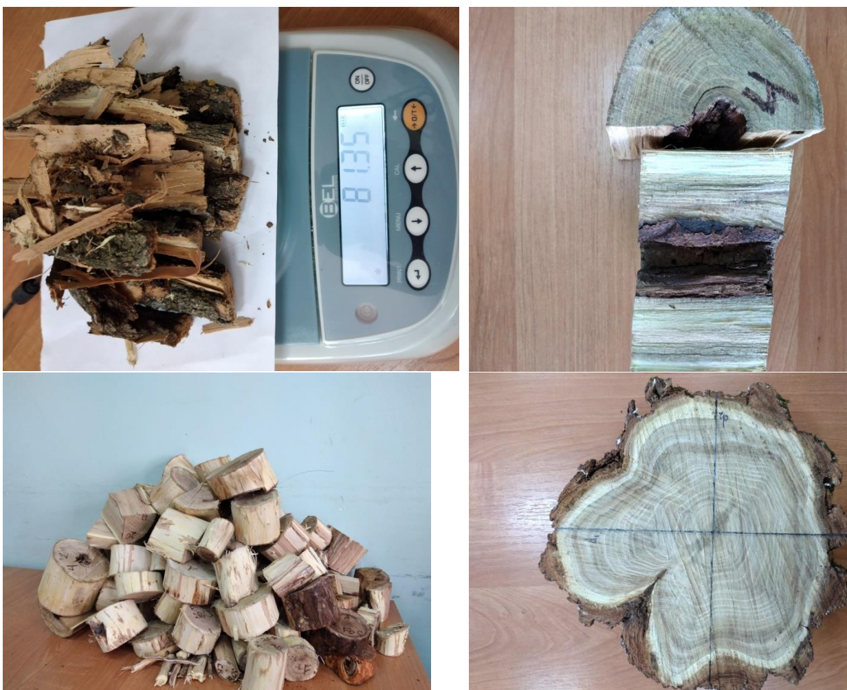
Figura 3.2.6. Preluarea indicilor dendrometrici în condiții de laborator
