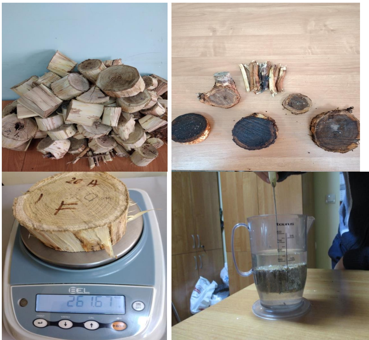
Figura 3.2.4. Preluarea indicilor dendrometrici în condiții de laborator
